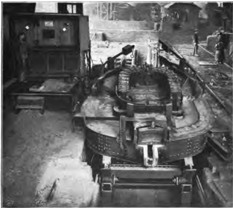
Röchling-Rodenhausers Drehstromofen in Völklingen.
